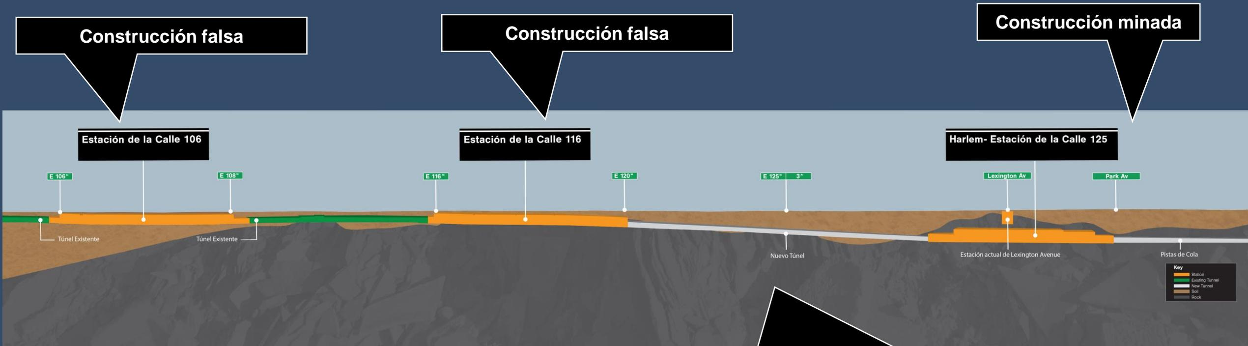
**Construcción de nuevos túneles usando perforadoras de túneles de presión de tierra**
